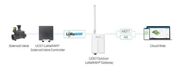
Con tecnologia LoraWAN se realizaron pruebas y estudios de campo en profundidad en Ningxia. Con base en los hallazgos, implementaron la puerta de enlace LoRaWAN® para exteriores UG67 y el controlador de válvula solenoide LoRaWAN® UC511 en tierras de cultivo para establecer una red de riego que ahorra agua para cultivos como maíz, papas, coliflor y apio.
